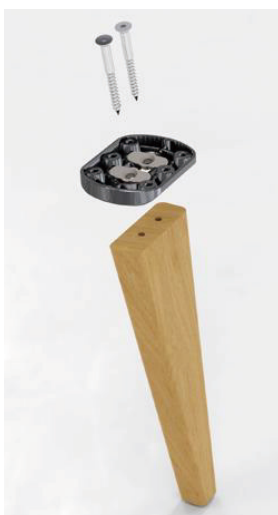
B142-WS 専用ネジ 7×80mm 本体1ヶに2本必要 (T30のトルクスドライバー専用)
