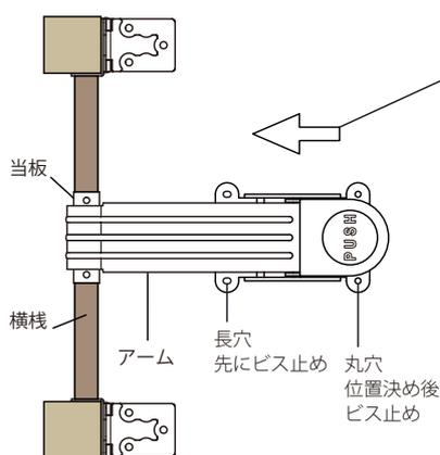
先に長穴側のビスを取付けて“アーム”と“当板”に隙間無いよう位置決めをしてから、丸穴側をビスで固定してください。
