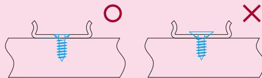
ネジはネジ穴に対して必ず水平にセットして下さい。
