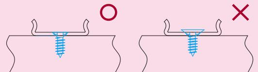
ネジはネジ穴に対して必ず水平にセットして下さい。
